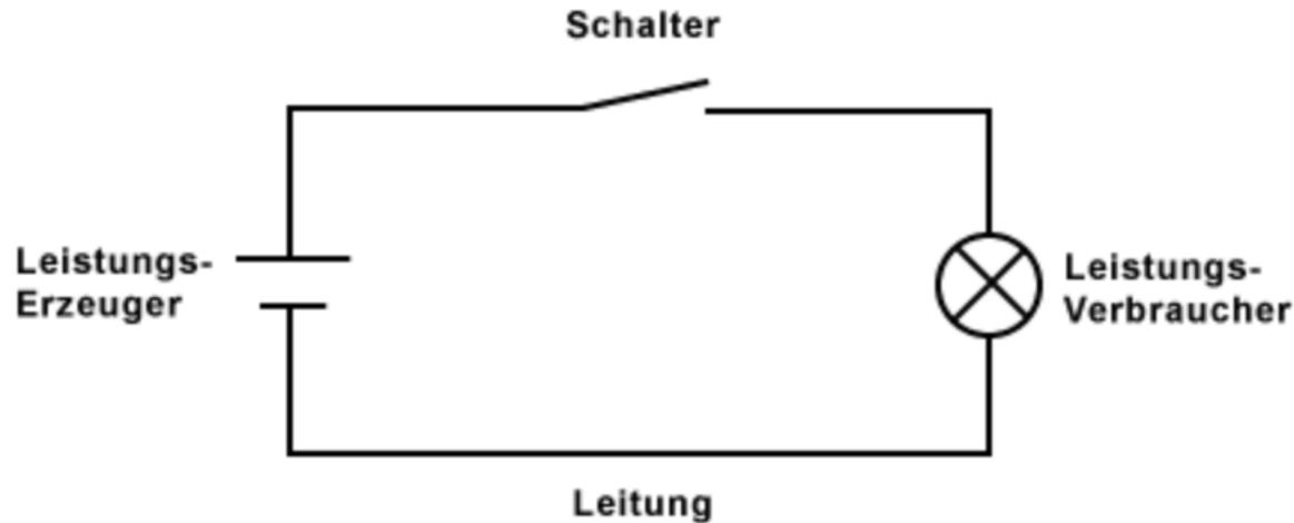
Ein **elektrischer Stromkreis** ist eine Zusammenschaltung einer oder mehrerer elektrischer Energiequellen und verschiedener elektrischer Bauelemente durch elektrische Leitungen.
